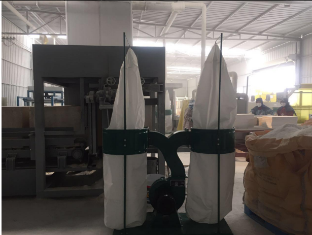
切割生产线双筒除尘器（2）
