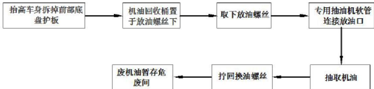
图 3-2 废机油收集工艺流程图
