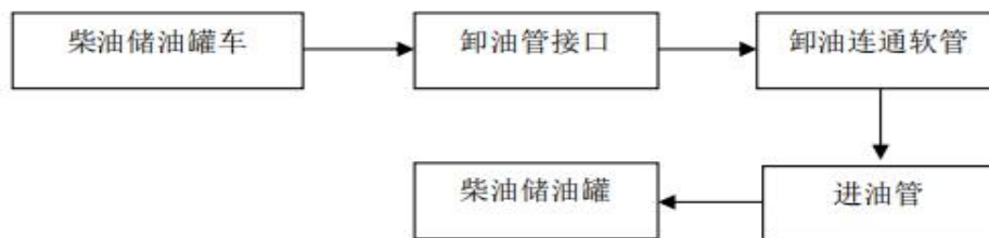
图3-4 加油站柴油卸油流程
