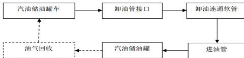
图3-3 加油站汽油卸油流程
